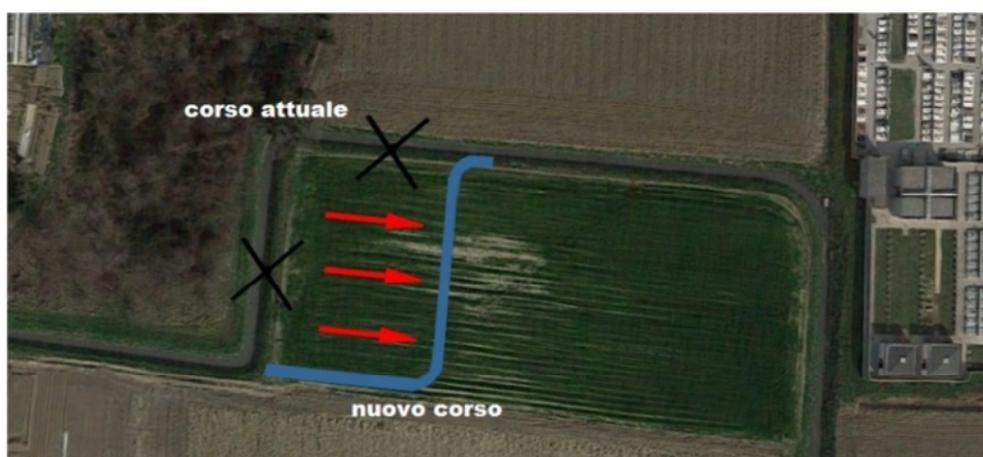
**Figura 11** – Schema della traslazione dello scolo Rusteghin
